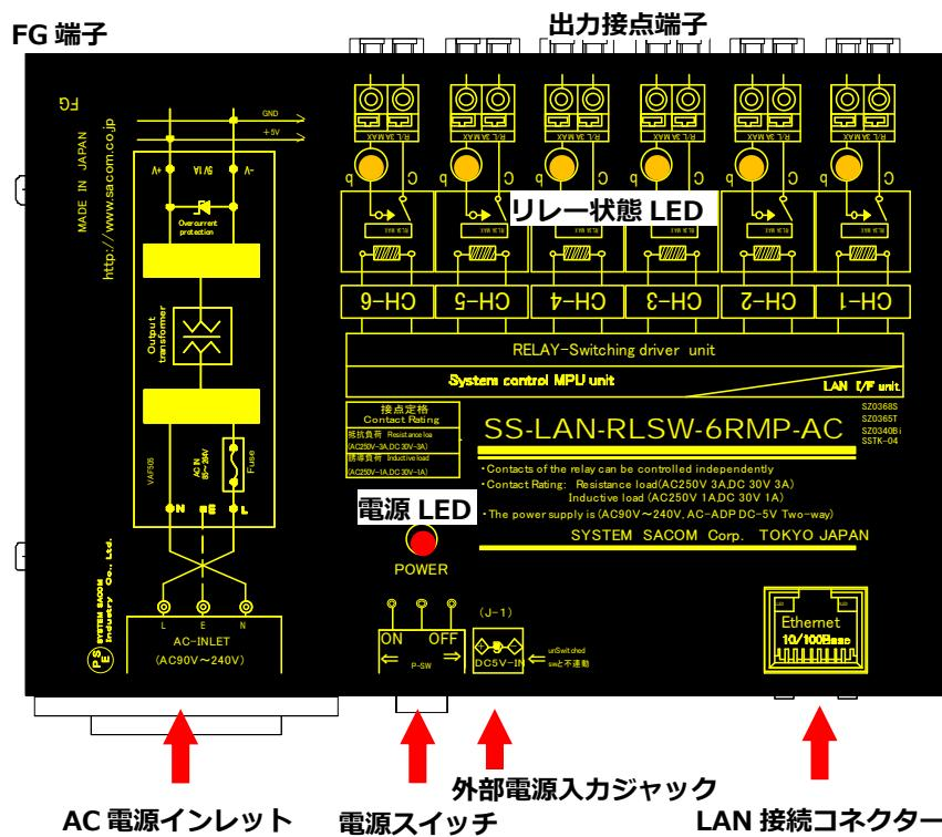
**LAN接続コネクター** LAN(Ethernet)に接続するRJ45コネクターです。カテゴリー5以上のLANケーブルでネットワークハブなどに接続します。
