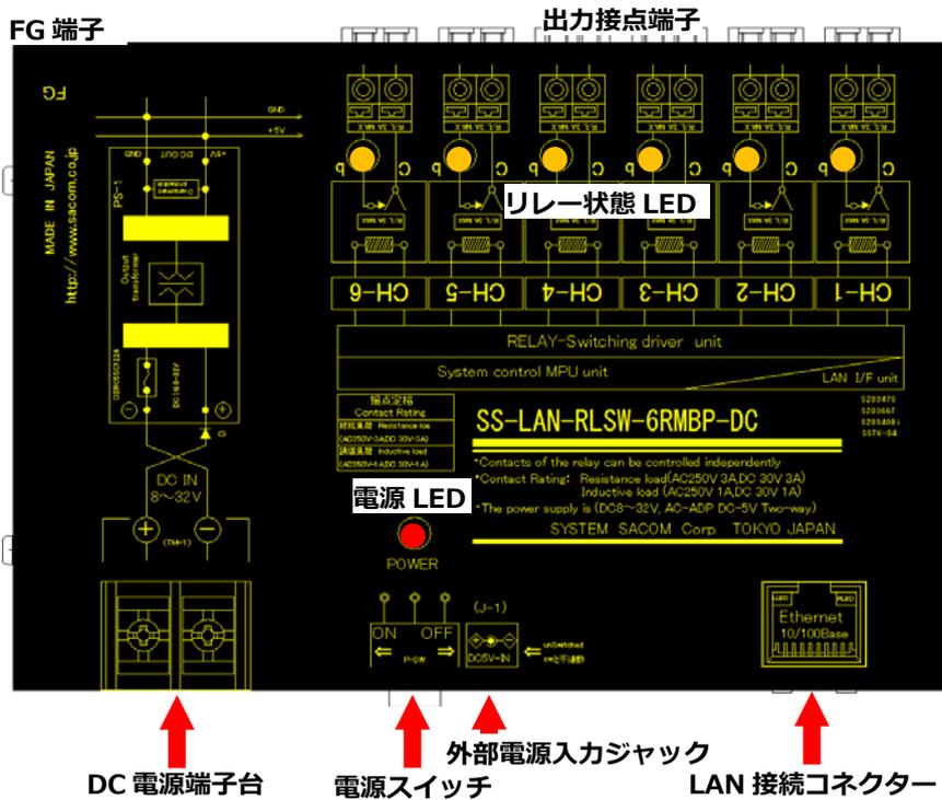
LAN接続コネクタ LAN(Ethernet)に接続するRJ45 コネクタです。カテゴリ5 以上のLANケーブルでネットワークハブなどに接続します。
