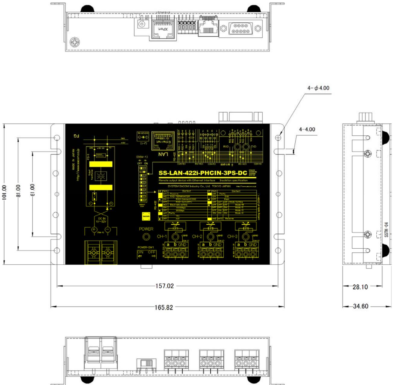
9.5. SS-LAN-422i-PHCIN-3PS-ADP (AC アダプター電源仕様) ・ 本体外形寸法図
