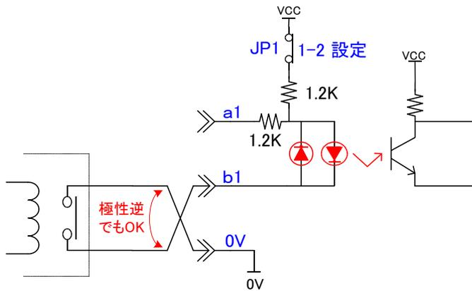
VCC には直列に 1.2k $\Omega$ (1W)が接続されます。また 0V と FG は DC-DC 電源ユニットにより絶縁されています。
