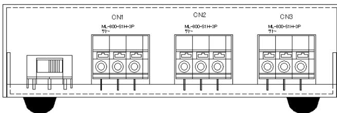
9.6. SS-LAN-422i-PHCIN-3PS-ADP (AC アダプター電源仕様)・取付金具寸法図
