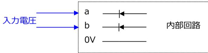
ab 端子への印加電圧は DC5~24V です。24V より高い電圧を印加すると、ツェナーダイオードの定格最大電流 30mA を超え、故障の原因となります。
