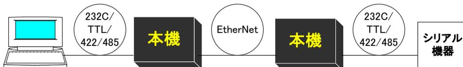
途中が LAN のシリアルトンネリングで HUB を経由し、複数の本機(別 IP アドレス)に対し、それぞれ区別して接続する方法です。
