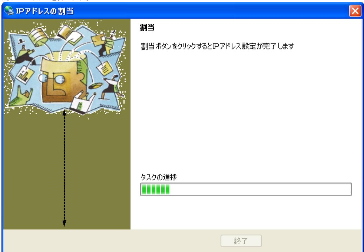
時間が経過すると「終了」ボタンが出ますのでそれを押して終わりです。DeviceInstaller のデバイス詳細のサポート: ダイナミック IP が Dynamically になっています。
