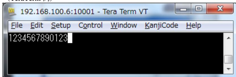
(接続例：本機エコーバック動作中に 123…と Key 入力したところ)
