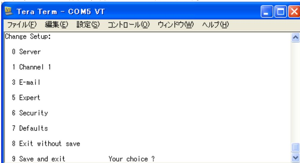
IP 変更ならば 0 を、初期化は (主な初期化値は、IP 自動、シリアルトンネリング設定はキャンセル、9600bps、1Stop、NoParity です。ご注意ください) 7 を、シリアル通信条件は 1 を選択します。詳細は SetupMenu.pdf をご覧ください。
