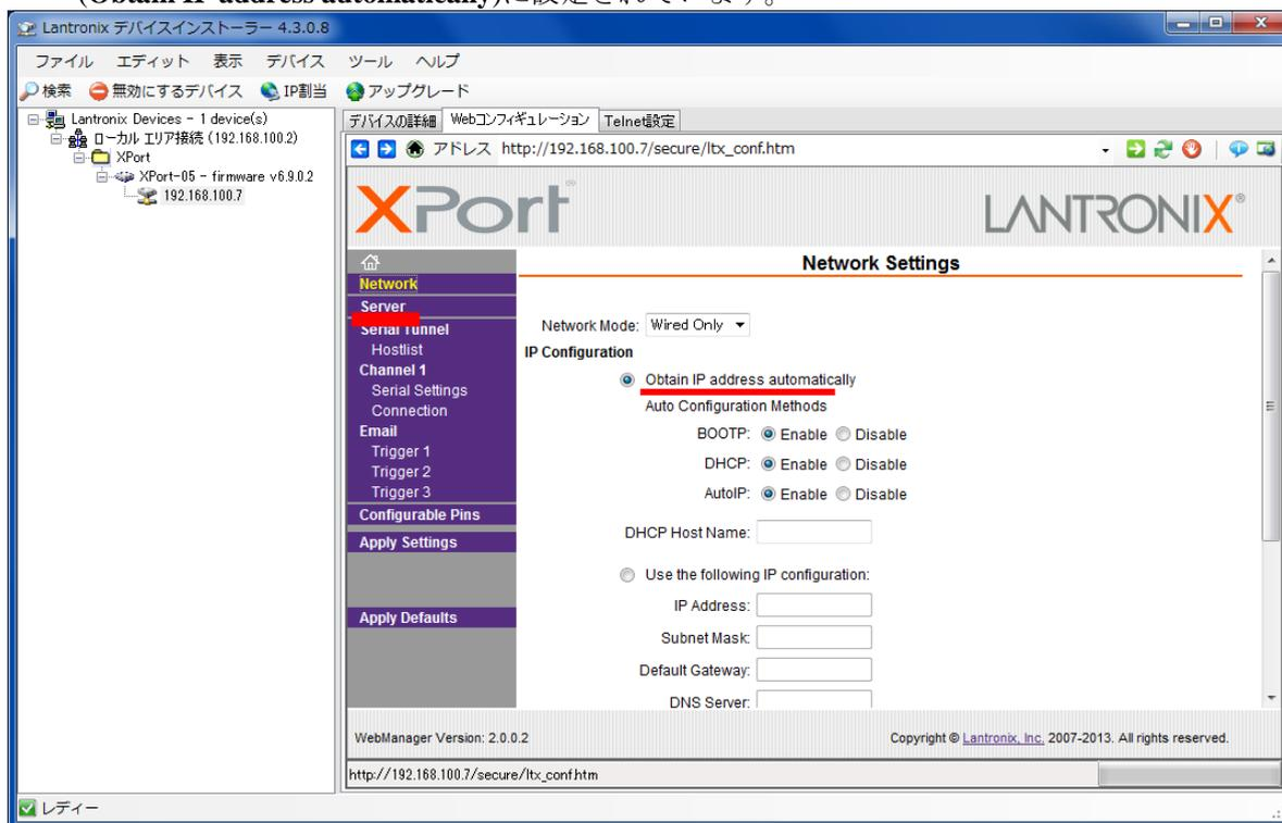
これを固定 IP モード (**Use the following IP configuration**) に変更し、本機を接続しているネットワーク環境に合わせた IP アドレス (**IP Address**)、サブネットマスク (**Subnet Mask**) と、必要であれば、デフォルトゲートウェイ (**Default Gateway**)、ネームサーバ (**DNS Server**) を入力します。
