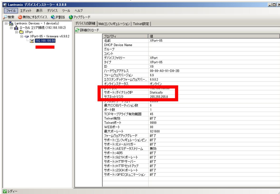
この例では変更前に Dynamically (自動取得) の 192.168.100.7 だった IP アドレスが 192.168.100.50 に Statically (固定 IP) アドレスに変更されていることが確認できます。(電源を切っても本機内に記憶されています)
