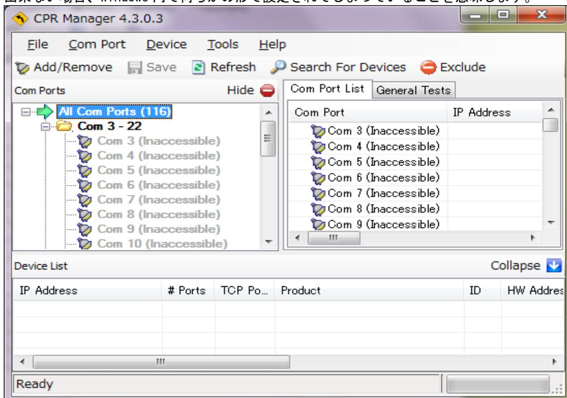
もし、そのようなグレー色の Com ポートを使いたい場合はデバイスマネージャに入り該当設定を消去する必要があります。上図では Com 3、4、5、6、などが使用中であり、仮想 COM を編集出来ない状態となっています。例として Com 4 の既存設定を消す手順を以下に記します。一旦 CPR マネージャを終了します。
