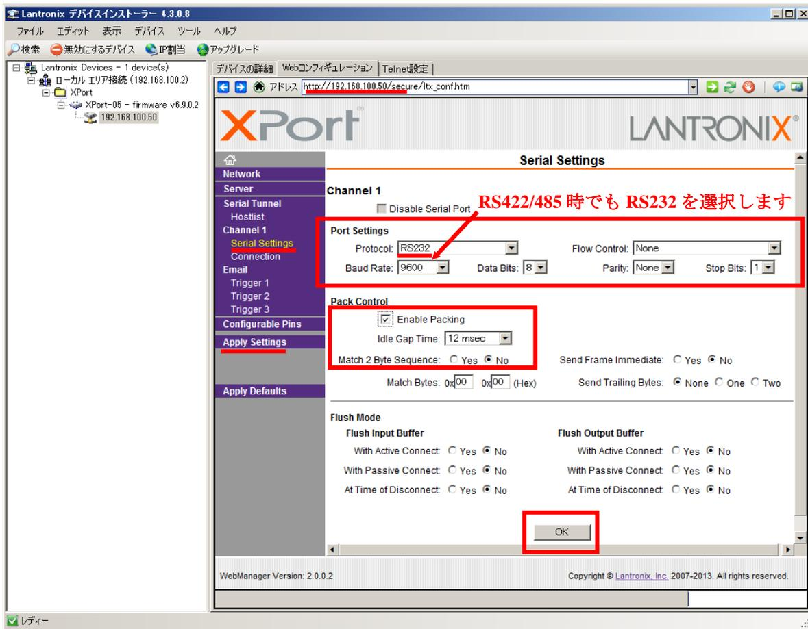
ここで通信速度 (Baud Rate : 初期状態は製品により異なります) 、データ長(Data Bits : 初期状態は 8)、フローコントロール (Flow Control : 初期状態は None) 、パリティ (Parity : 初期状態は None) 、ストップビット(StopBits : 初期状態は 1)を変更できます。ただし**プロトコル**(Protocol : 初期状態は)は RS422/485 でご利用の場合も **RS232 固定**に設定してください。(但し一部の機器は異なります)
