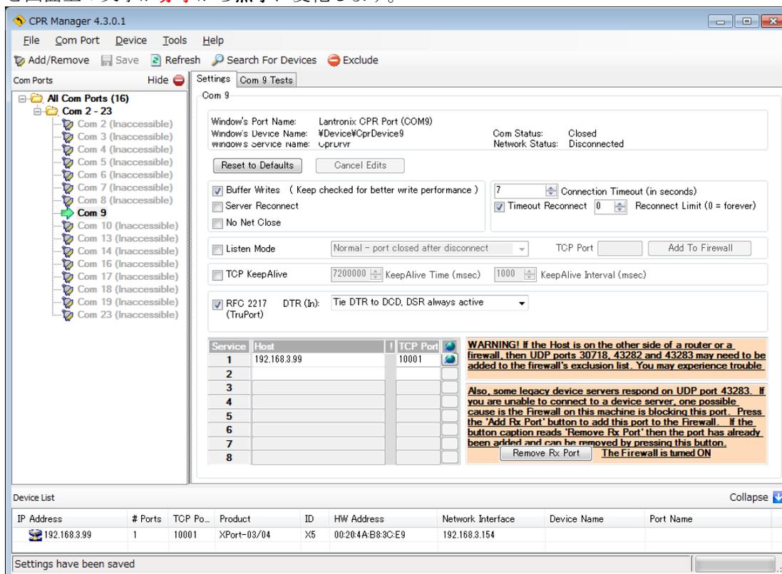
③ テスト例：TABのCom9（例）Testsをクリックし、Open ボタンをクリックして接続テストを行います。
